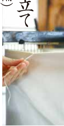
粹掛け作業(紐通し)
